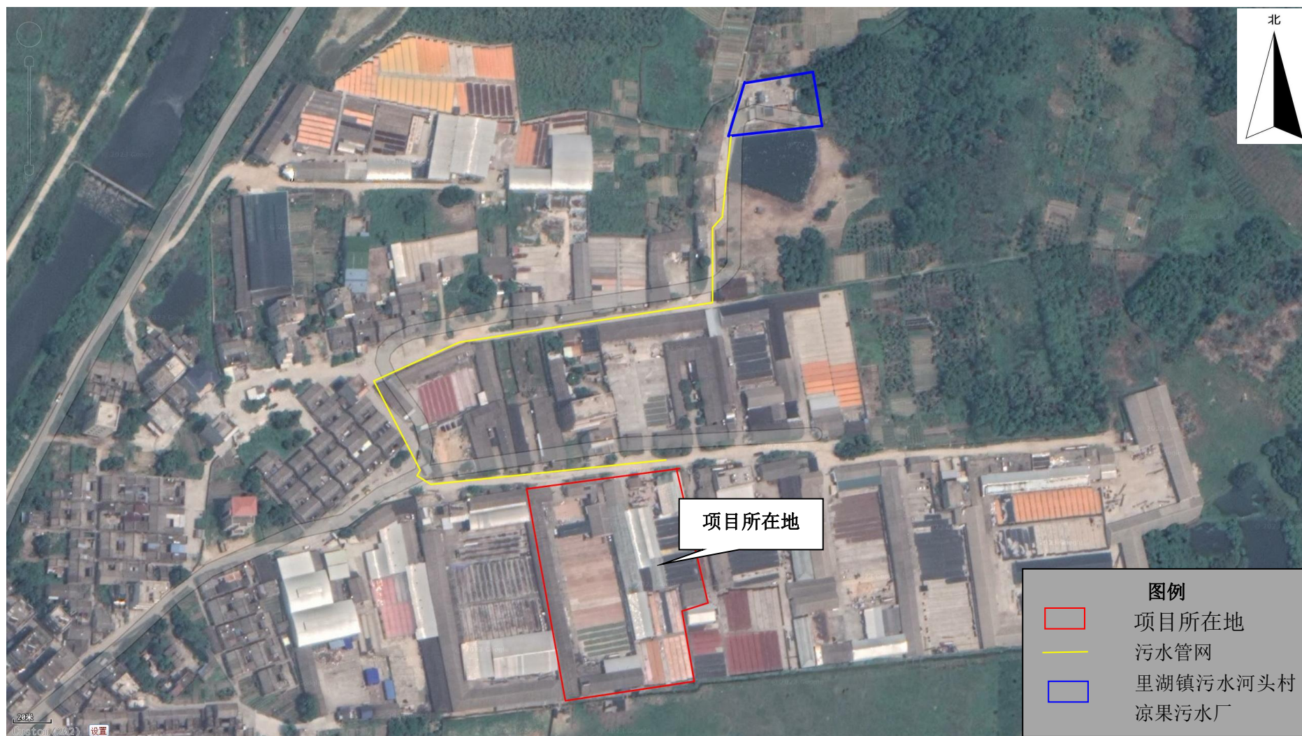
附图 12 纳污水厂的污水管网图
